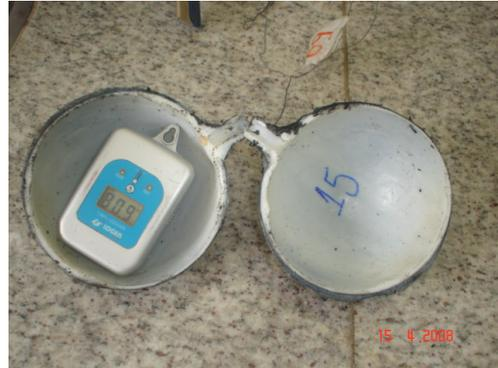
Figura 7 – Sensor acoplado a um minidatalogger “ALPAX” para coleta de temperatura de globo °C
