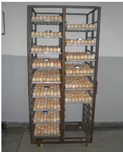
Figura 21 – Representação da disposição das bandejas de ovos no carrinho e os seis microprocessadores para os diferentes tempos de estocagem e suas respectivas idades de matrizes, na sala climatizada
