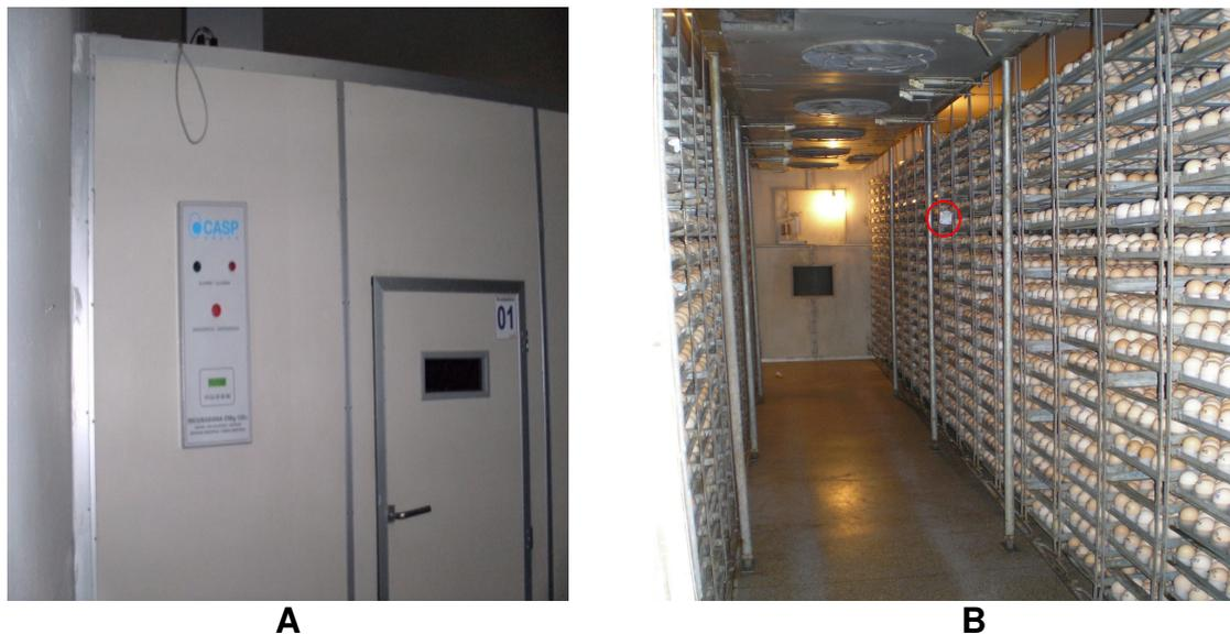
Figura 22 – Vista externa (A) e interna (B) da incubadora e alocação do microprocessador (círculo vermelho)
