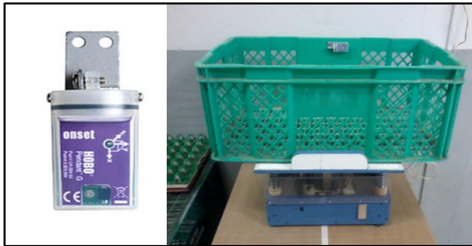
Figura - Acelerômetro HOB0 Pendant G UA-004-64 ® fixado em uma caixa de transporte convencional para as simulações
