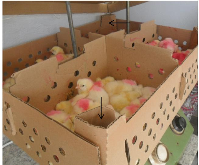
**Figura 1.** Simulação de um tratamento de vibração. As flechas indicam o local de posicionamento dos acelerômetros
