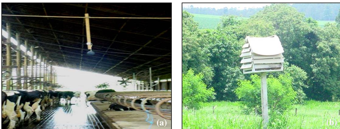
Figura 8 - Vista dos sistemas eletrônicos de aquisição de dados meteorológicos instalados no ambiente interno (a) e externo ao *freestall* (b)
