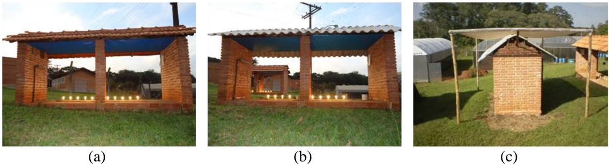
Figura 5 – Vista lateral do modelo com forro sob a cobertura de Telha Cerâmica (a), vista lateral do modelo com forro sob a cobertura de Telha Fibrocimento (b) e vista frontal do modelo com forro sobre a cobertura de Telha Fibrocimento (c)
