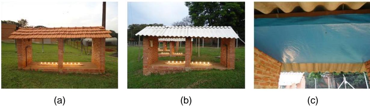
Figura 3 - Vista lateral do modelo com Telha Cerâmica (a), vista lateral do modelo com Telha Fibrocimento (b) e vista interna do modelo com forro (c)
