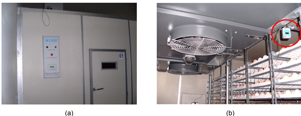
Figura 2 – Vista externa (a) e interna (b) da incubadora e alocação do datalogger (círculo vermelho)
