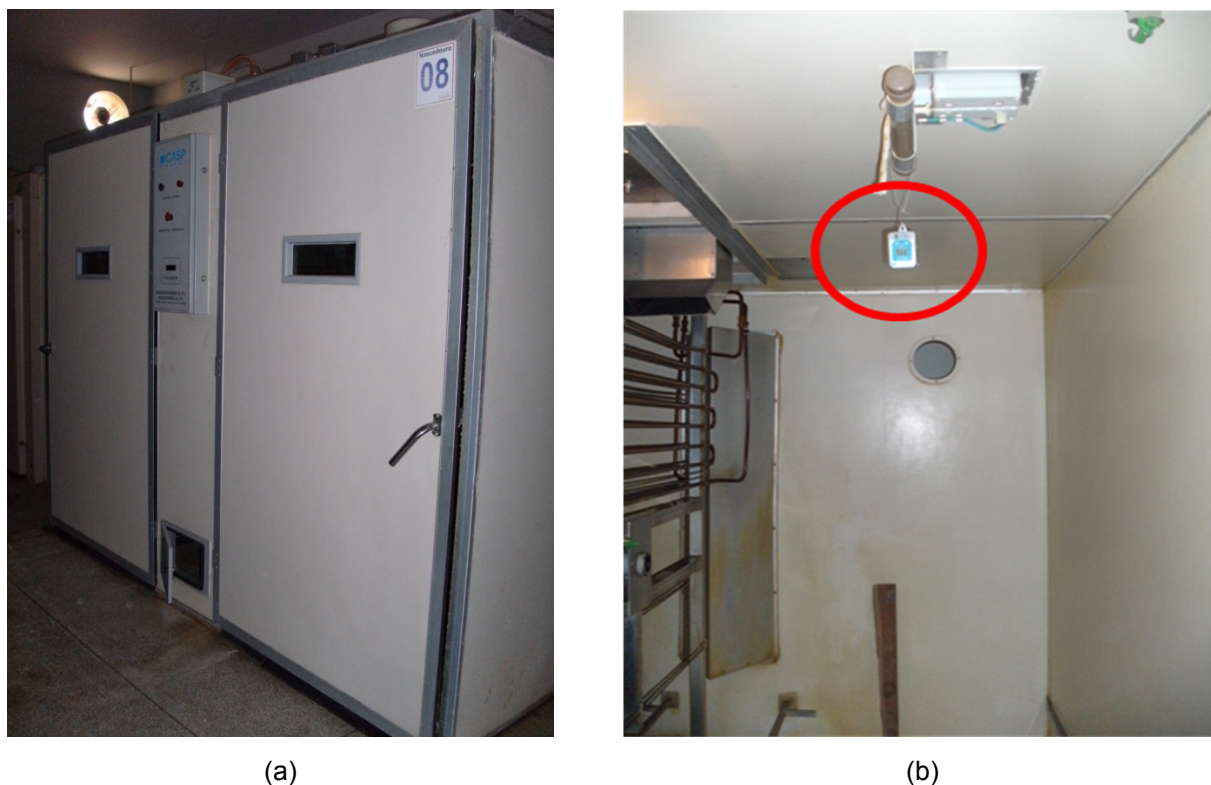
Figura 3 – Vista externa (a) e interna (b) do nascedouro e alocação do datalogger (círculo vermelho)
