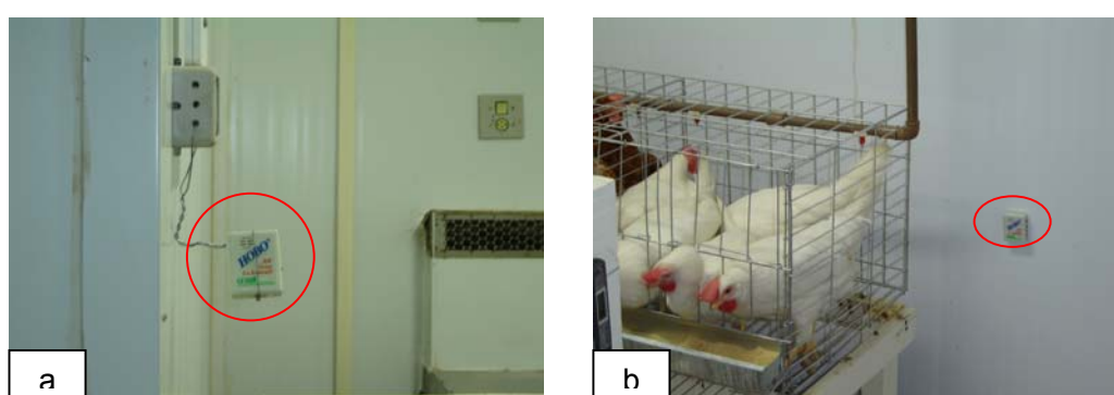
Figura 5 – Detalhe de duas miniestações meteorológicas instaladas respectivamente a 1,70m (a) e 0,5m (b) de altura com relação ao piso da câmara climática
