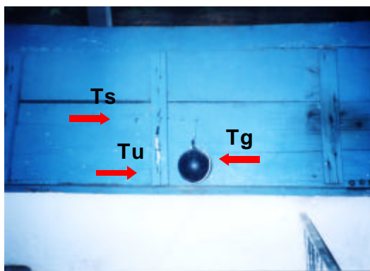
Figura 6 - Sensores acoplados na tampa do abrigo escamoteador.
