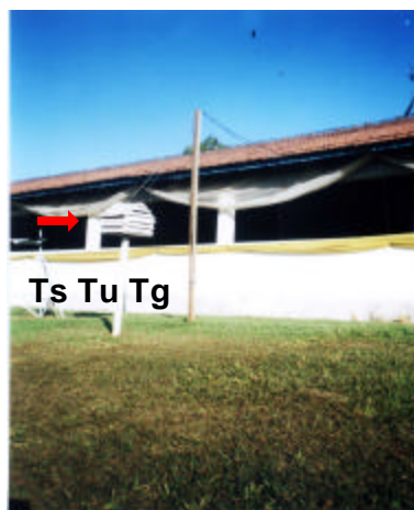
Figura 8 - Abrigo meteorológico instalado no ambiente externo, próximo à sala da maternidade.
