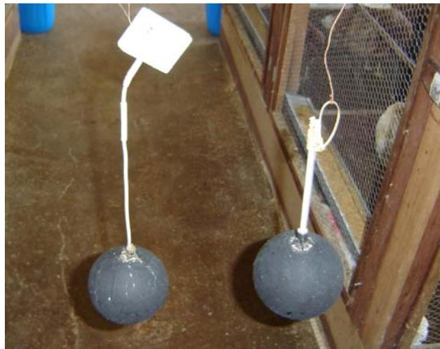
Figura 5 – Mini datalogger com globo negro e globo negro analógico
