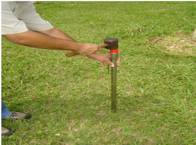
Figura 7 - Vista da coleta de solo na áreas experimentais das amostras indeformadas
