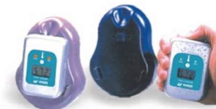
Figura 2- logger para registro de temperatura e umidade relativa.
