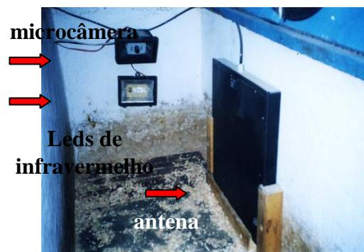
Figura 21: Microcâmera, leds de infravermelho e antena de captação do sinal dos microchips, instalados no interior do abrigo escamoteador.
