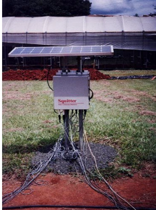
Figura 5 - Sistema de aquisição de dados instalado na área experimental do NUPEA/DER/ESALQ/USP, a partir da fase II.
