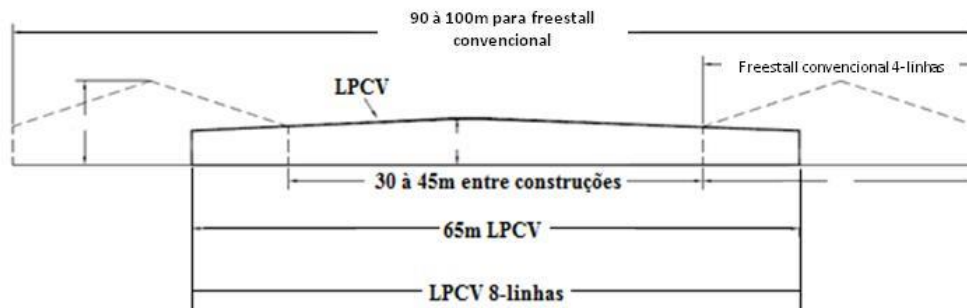
Figura 2. Comparação entre dois galpões freestall ventilado naturalmente de 4 linhas, totalizando 8 linhas, e um galpão freestall LPCV de 8 linhas. Adaptado de Smith et al. (2007)
